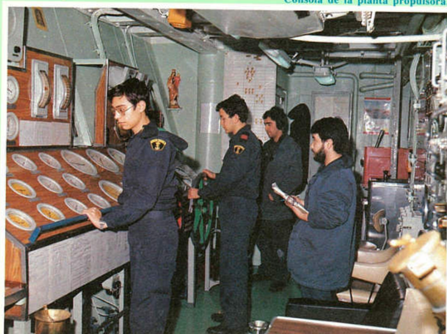
Consola de la planta propulsora.
