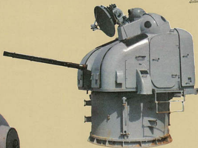
MEROKA, sistema antimisil de vuelo rasante, muy alto ritmo de fuego. Fabricación española, 12 tubos de 20 m/m en dos hileras de seis.
